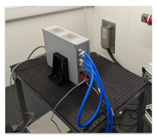
*HEXITEC*<sub>MHz</sub> test enclosure (exterior)
