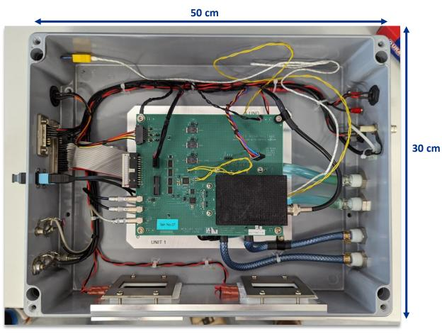
*HEXITEC*<sub>*MHz</sub>test enclosure* (*interior*)</sub>
