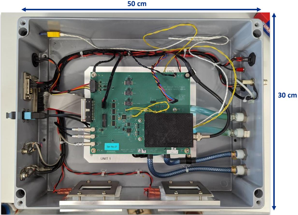
*HEXITEC<sub>MHz</sub> test enclosure (interior)*
