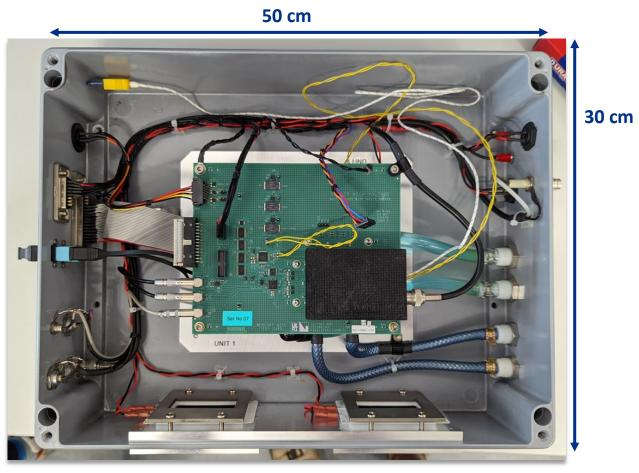
*HEXITEC*<sub>MHz</sub> test enclosure
